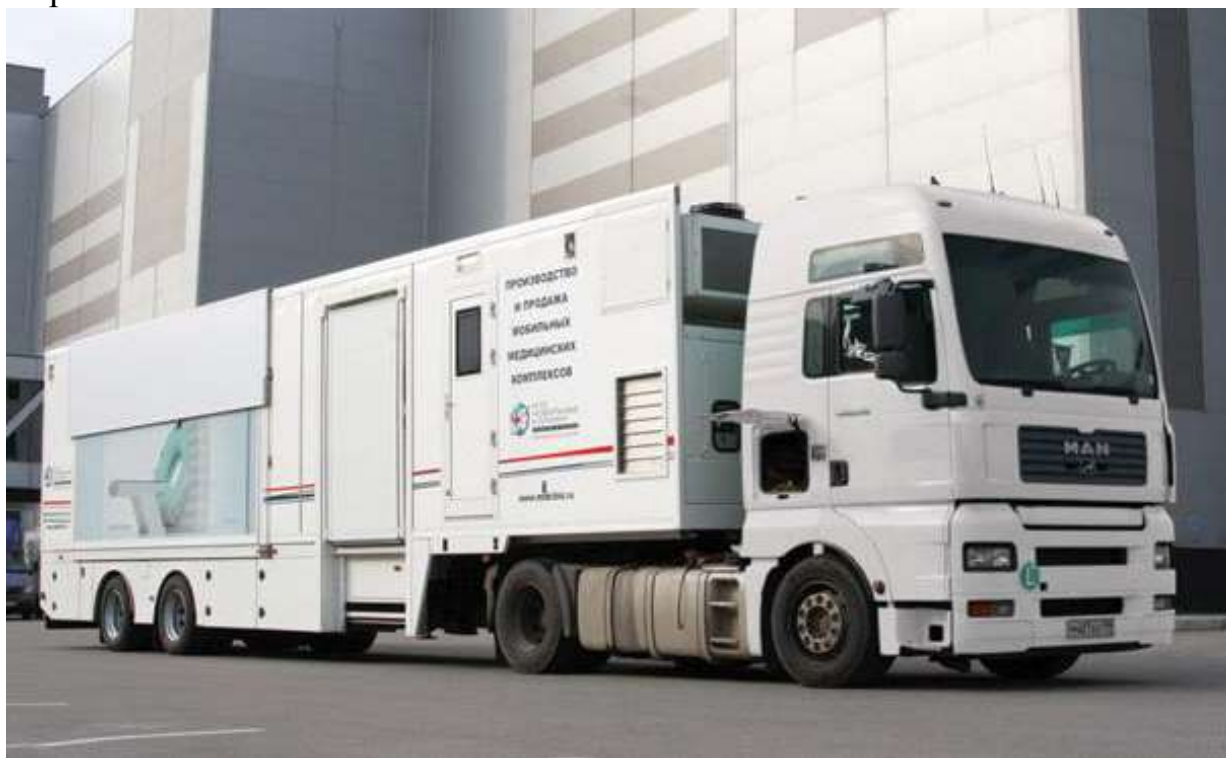
Передвижная криминалистическая лаборатория (ПКЛ) – мобильный комплекс КТ с изменяемой геометрией кузова на базе полуприцепа.
